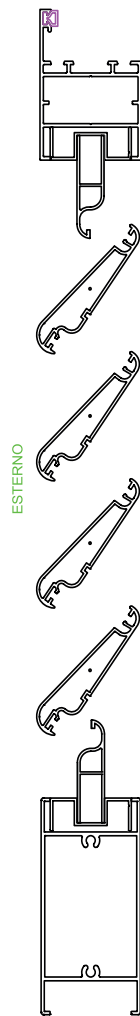
LAMELLA ORIENTABILE IN POSIZIONE DI APERTURA
